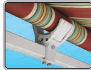
■巻取サポート 【特許出願済】 ※巻取サポートはポリエステル系キャンバス使用時での設定を推奨します。2ピース構造の採用により、取付取外し及びメンテナンスも容易です。抜け出し防止の形状で巻取パイプのたわみ・はずれを防止します。回転ベルトのガイドにより、キャンバスの耐久性を高めています。
