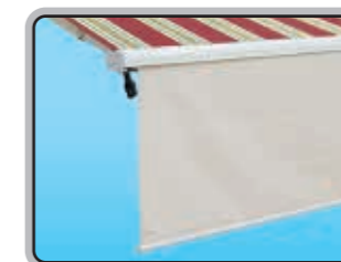
■ローリングシェード前枠 (オプション：6間用間口までの設定) 西日などの直射日光から視界を妨げることなく商品を守ります。(ウェーブキャンバス仕様の場合) 又、操作ハンドルは5種類の長さから選べます。(ギア比 3:1)
